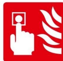
دکمه اعلام حریق
